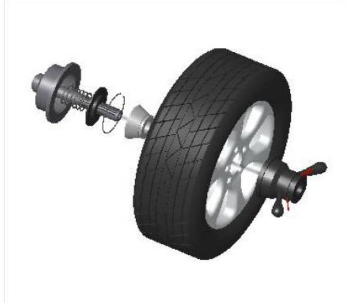
**Achtung: Halten Sie das Rad während dem Spannvorgang fest. Beim Einsetzen oder Abnehmen des Rades darf das Rad nicht auf die Welle schleifen.**
