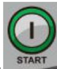
3. Schließen Sie den Radschutzbogen oder drücken Sie die
