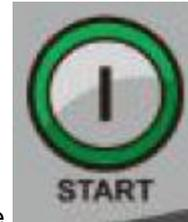
2. Legen Sie die Messlehre an der Hauptwelle an (Abb.13) und drücken Sie die
