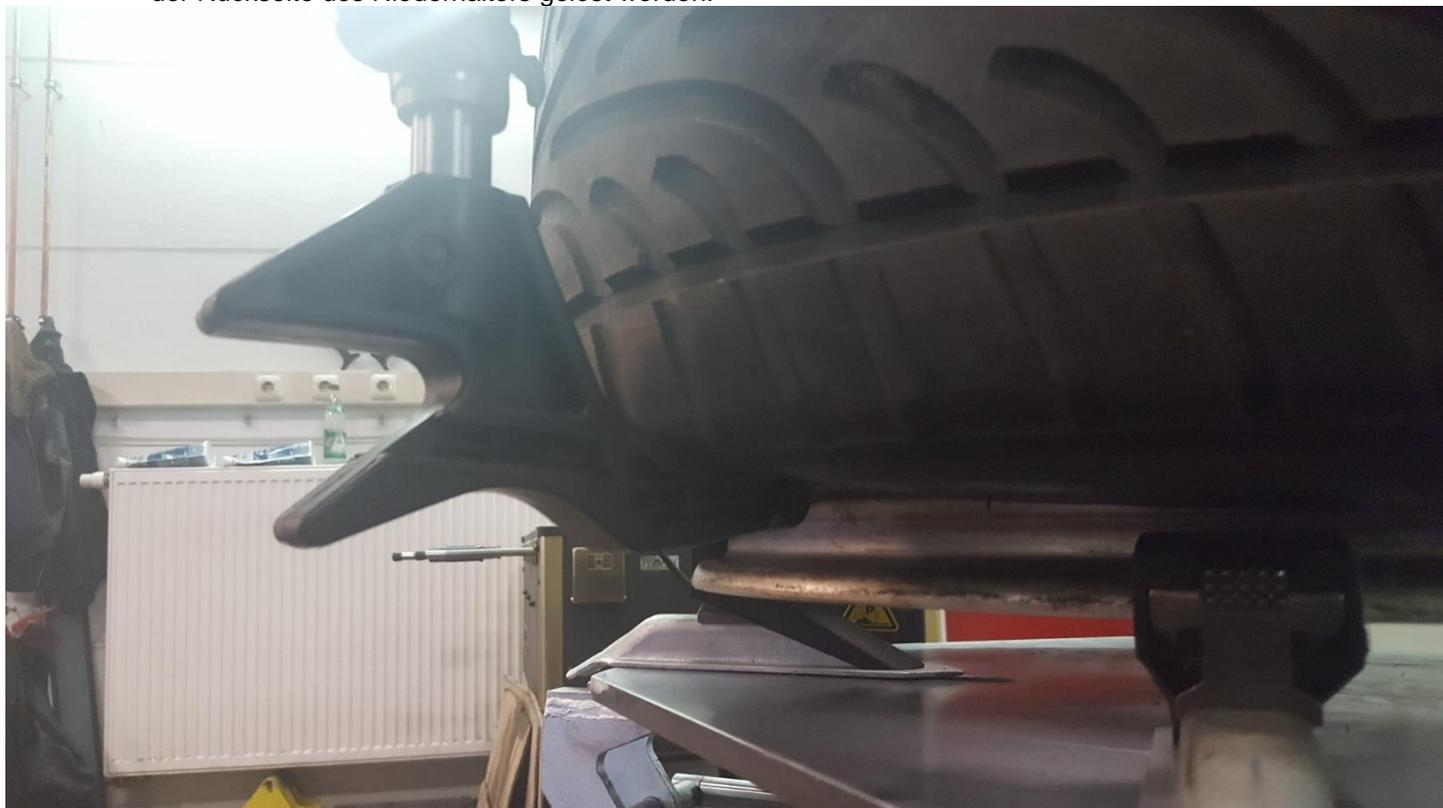
i. Heben Sie den Reifen in Felgenwulst an und demontieren Sie wie gehabt die zweite Wulst.
