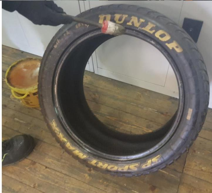
b. Die erste Wulst des Reifens so gut wie möglich manuell in die Felge eindrehen und mit einer kurzen Drehbewegung montieren
