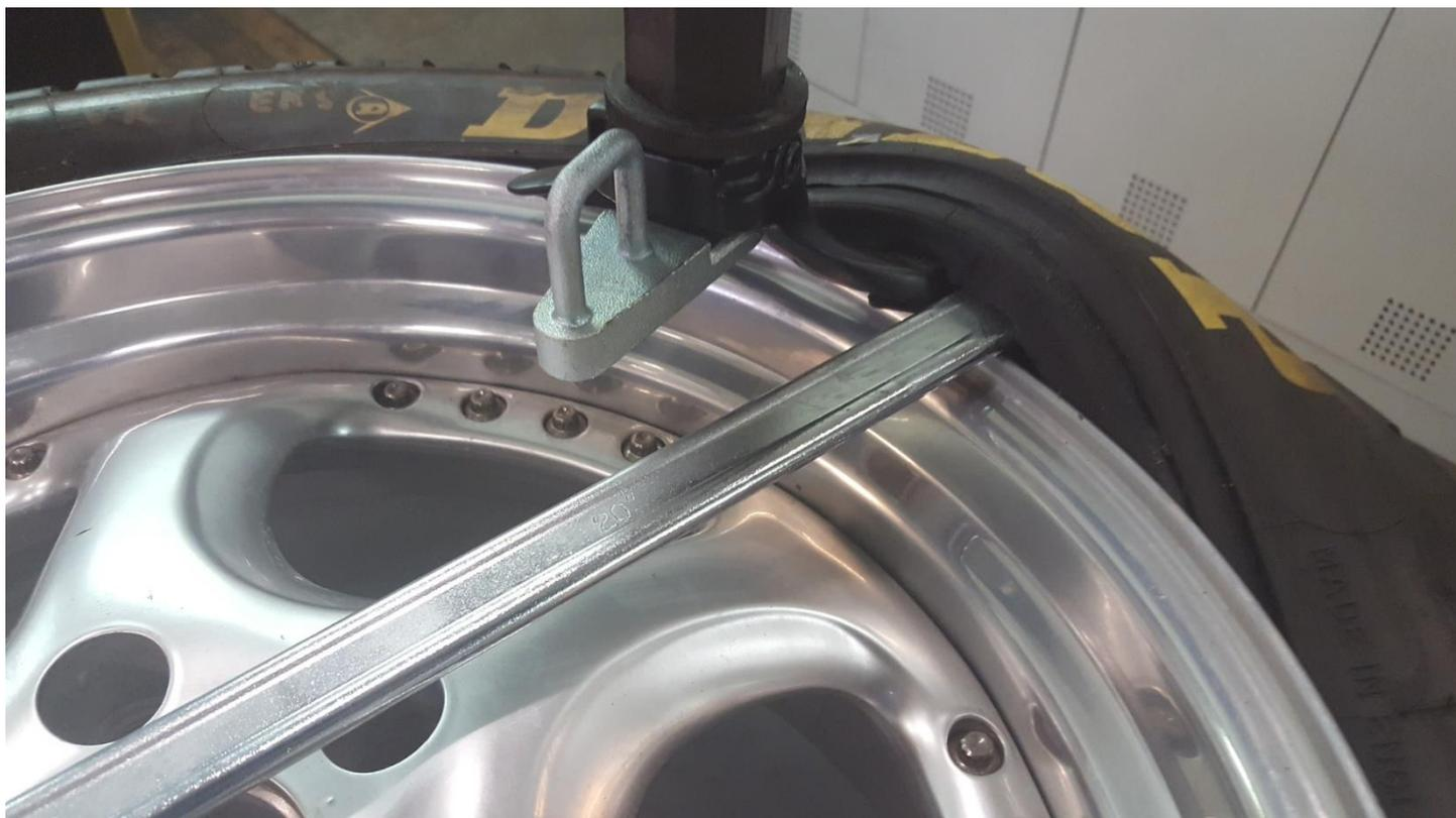
g. Wulstniederhalter zurücknehmen und im Uhrzeigersinn den Reifen abmontieren.
